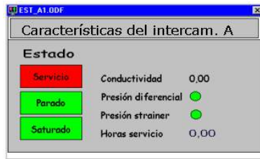
Figura 7.16: Ventana de características de un intercambiador.
