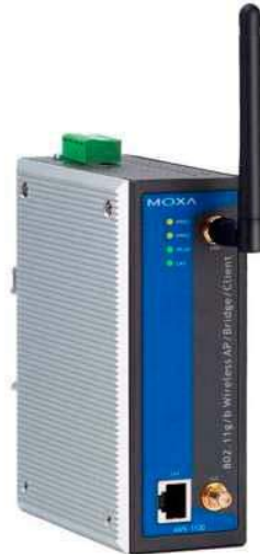
Figura 7.8: Imagen del componente MOXA AWR-1100 de OMRON.
