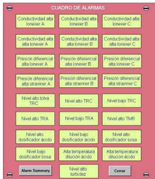
Figura 7.19: Ventana de alarmas.
